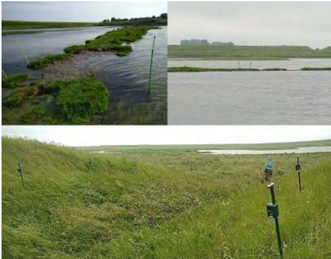
Figuur 2.16. Experimenten in onderzoeksgebied Ruidhorn. Boven Schapengaas stroomraster en twee ultrasone verjagers op dam. Onder vier ultrasone verjagers in dijkopening
