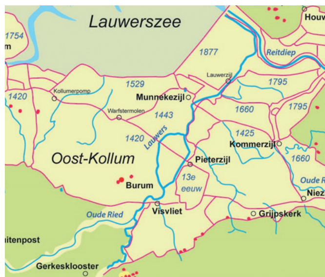
Links: De eerste bedijking van de Lauwerszee. De dijken zijn met rode lijnen aangegeven. Rechts: De inpolderingen van de Lauwerszee.
